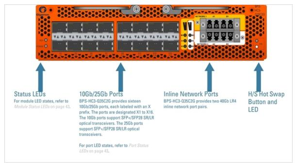
Figure 12: BPS-HC3-Q35C2G Module
